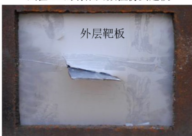
(a) 试验#32靶板损伤和叶片的嵌入情况
